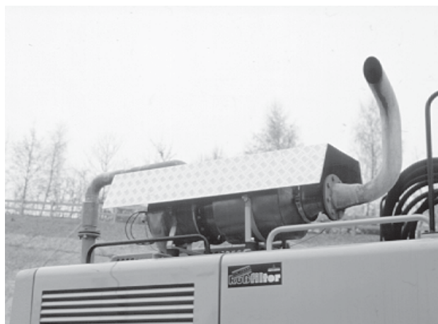
Filtro KHD/DSI su bagger cingolato Liebherr 942. Per le prove sul cantiere è stata tollerata la limitazione della visuale del macchinista. Nel caso normale il filtro dovrebbe essere montato sotto il cofano del motore.
