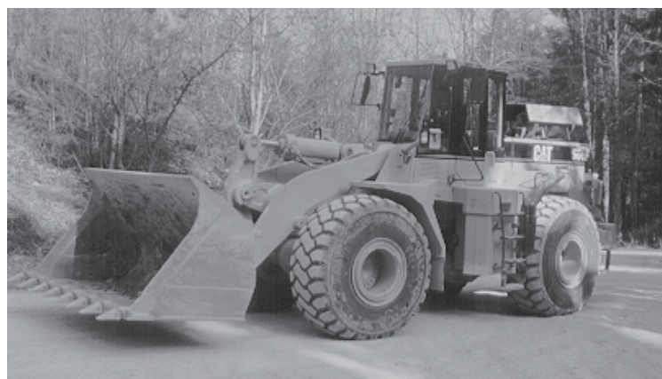
Figura 1: Caricatrice su ruote 966 F provvista di un filtro antifuliggine DSI, in azione su un cantiere in condizioni di lavoro difficili.
