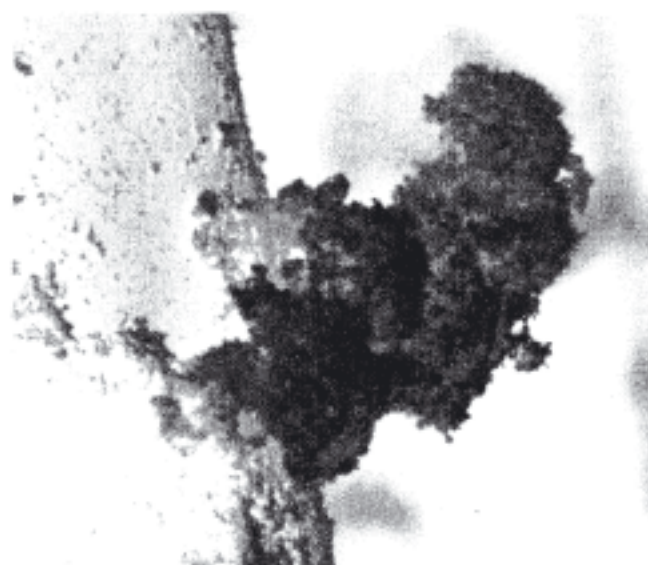
Figura 1: fuliggine da Diesel, emessa come particolato fine e agglomerato su una fibra ceramica del diametro di 10 \mu .
