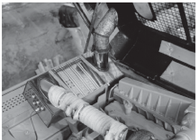
Filtro SHW su bagger cingolato CAT 330 al posto del silenziatore del tubo di scappamento.
