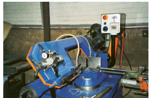
3 Das Sägeblatt ist bis auf den Schnittbereich vollständig verdeckt.
