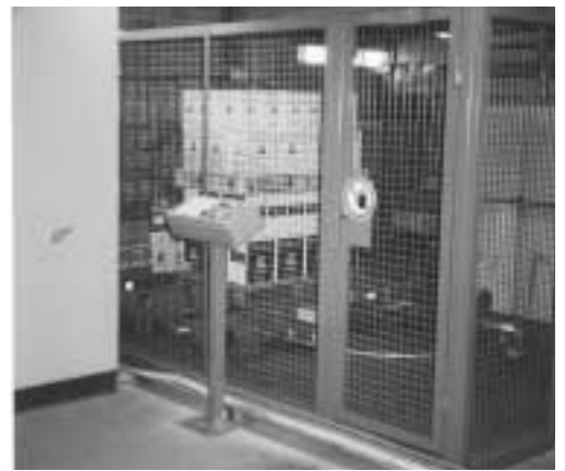
Figure 6: installation avec chariot de transfert et table tournante, intégrée dans une enceinte avec une porte surveillée.
