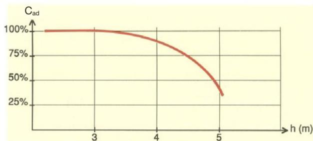
1 La capacité de charge ( $C_{ad}$  = charge admissible en %) décroît en fonction de la longueur d'extension (m). Les étais selon SN EN 1065 (classes D et E) ont une capacité de charge garantie pour chaque développement.
