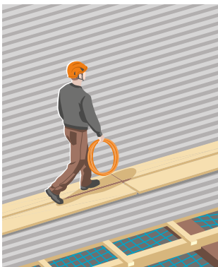
Regel 5 Durchbruchssichere Dachflächen.
