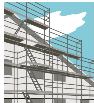
3 Zugang auf ein Steildach über ein Gerüst mit Treppenturm
