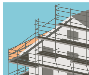
3 Steildach mit Spenglergang und Giebelschutz
