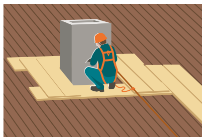
2 Durchbruchssicherer Arbeitsplatz mit Bretterbelag und zusätzlichem Anseilschutz (siehe Regel 8)
