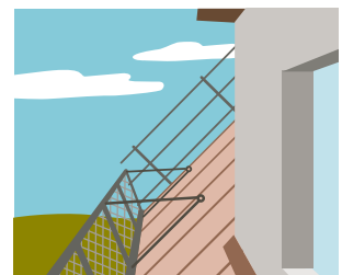
4 Fest installierte Dachfangwand und Giebelschutz auf bestehendem Dach
