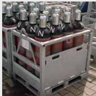
Fig. 16 Sécurisation des bouteilles à gaz
