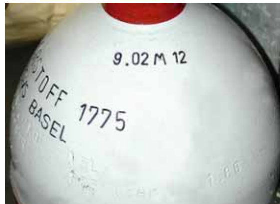
Fig. 24 Date du contrôle sur l'ogive de la bouteille à gaz
