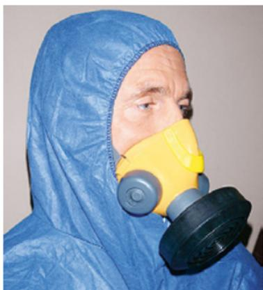
Halbmaske mit auswechselbarem Filter P3
