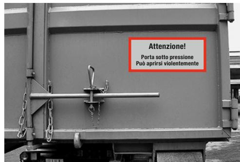
1 Container in buono stato con etichetta indicante il pericolo di improvvisa apertura dello sportello.
