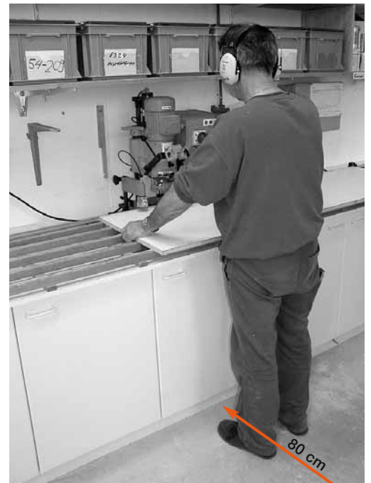
Figure 5: l'opérateur a besoin d'un espace libre d'au minimum 80 cm.
