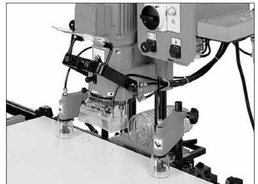
Figure 3: cylindres de serrage recouverts de collerettes de protection.
