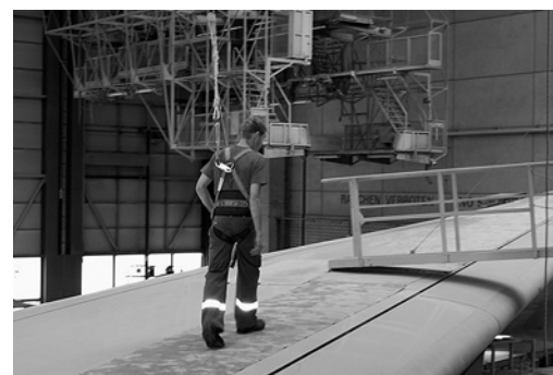
7 Absturzsicherung beim Verlassen des Arbeitspodests
