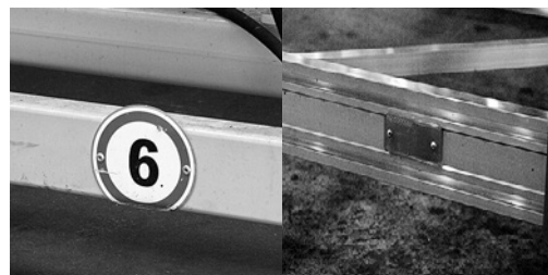
4 Deutliche Kennzeichnung der Höchstgeschwindigkeit. Reflektor für die Sichtbarkeit bei Dunkelheit
