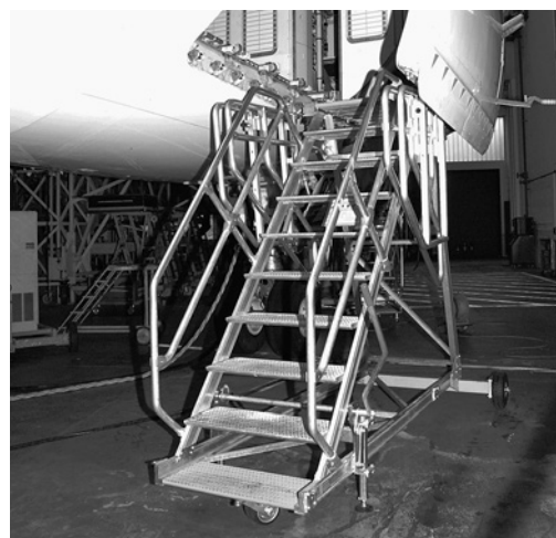
2 Gegen Verschieben gesicherte Wartungstreppe mit heruntergeklappten Geländerteilen
