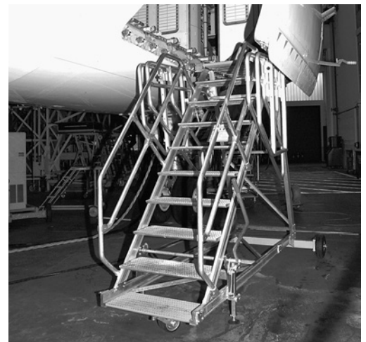
2 Gegen Verschieben gesicherte Wartungstreppe mit heruntergeklappten Geländerteilen
