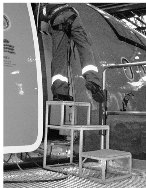
6 Absturzsicherung beim Einsatz eines Dreitritts
