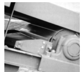
Figure 4: dans le cas des tambours de déviation, un racleur fermé a fait ses preuves comme protection de la zone d'entraînement.
