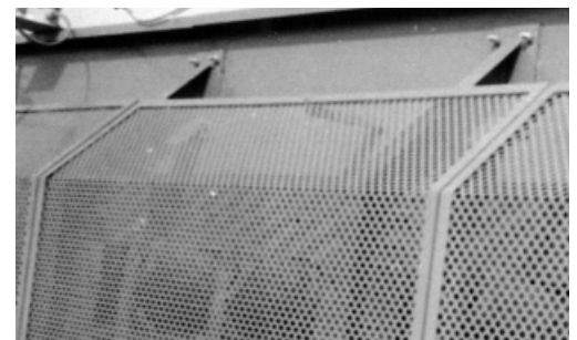
Figure 5: grillage latéral protégeant les zones d'entraînement des galets porteurs où la bande ne peut pas se soulever suffisamment.
