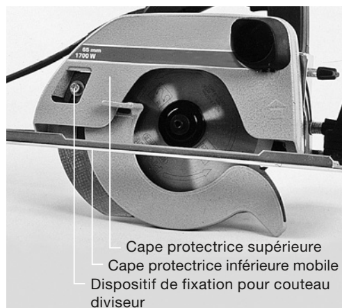
1 Scie circulaire à main protégée correctement.
