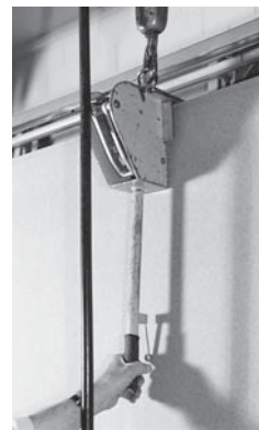
Fig. 4: grazie al peso proprio con il baricentro in basso l'organo di presa non si stacca anche quando non è sotto trazione.
