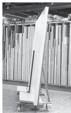
Fig. 3: dispositivo antiribaltamento: se i pannelli non sono fissati, il carrello non può essere spostato.
