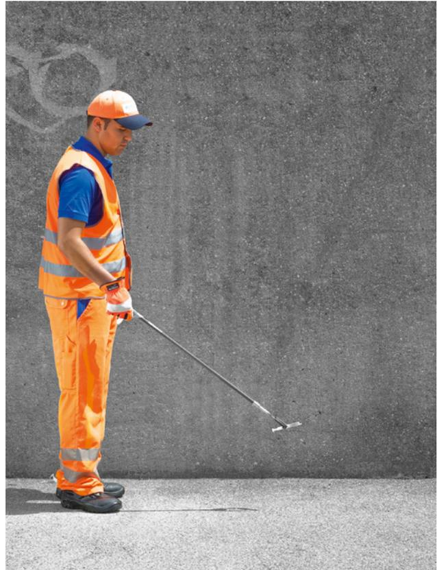
3 Für die Entsorgung spitzer und scharfkantiger Gegenstände verwenden Sie geeignete Greifinstrumente.
