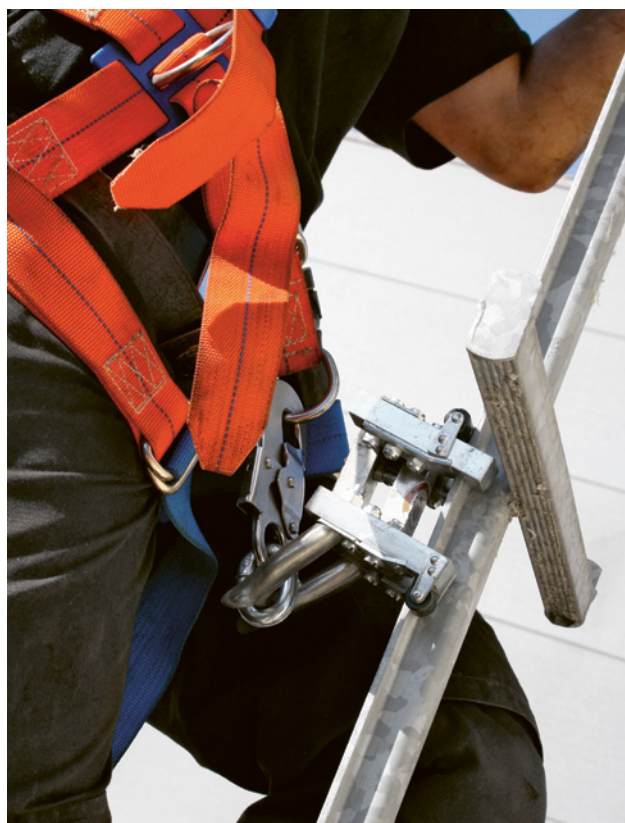
8 Corsore del dispositivo anticaduta di tipo guidato (dettaglio fig. 7)
