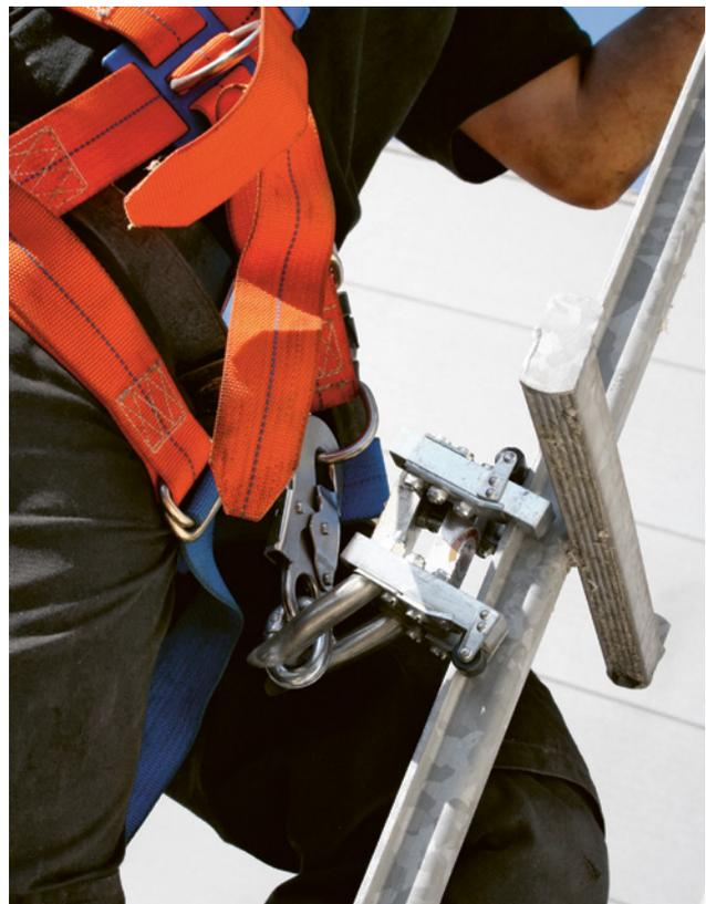
8 Corsore del dispositivo anticaduta di tipo guidato (dettaglio fig. 7)
