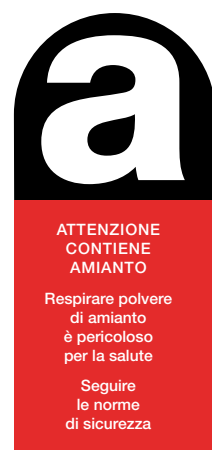
3 Etichetta adesiva «Attenzione contiene amianto»
