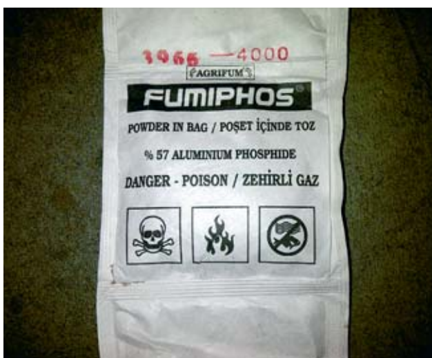
Fig. 2: sachet retrouvé dans un conteneur et renfermant du phosphore d'aluminium (dégage de l'hydrogène phosphoré en cas de contact avec l'humidité ambiante)
