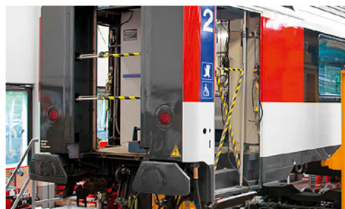
7 Sicherungsstangen gegen Absturz
