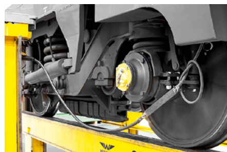
14 angehobenes und geerdetes Fahrzeug
