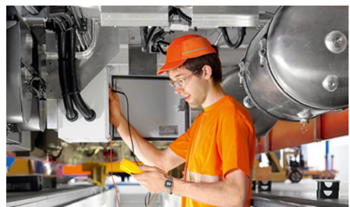
4 Bei Arbeiten unter den Fahrzeugen besteht die Tragpflicht eines Kopfschutzes (Anstoskappe oder Schutzhelm)
