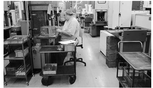
Fig. 1: prevedere uno spazio libero di almeno 800 mm per consentire all'operatore sufficiente libertà di movimento.
