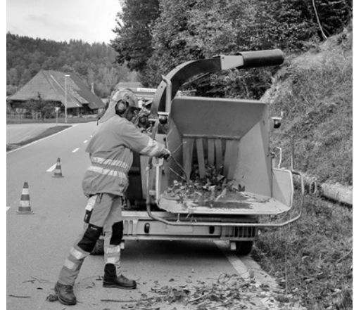
1 Der seitlich und unterhalb des Buschholzhackers angebrachte Schaltbügel übernimmt auch die Funktion einer Stoppvorrichtung. Zusätzlich gibt es zwei Not-Halt-Einrichtungen.
