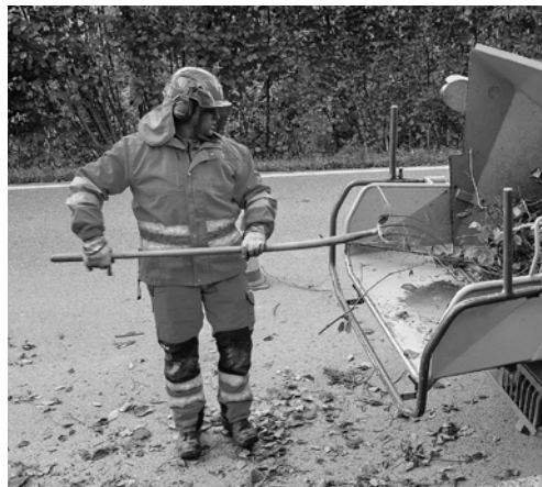
6 Zur persönlichen Schutzausrüstung gehören in der Regel Helm, Augen- und Gehörschutz, festes Schuhwerk sowie anliegende Warnkleidung und Handschuhe mit enganliegendem Bund.
