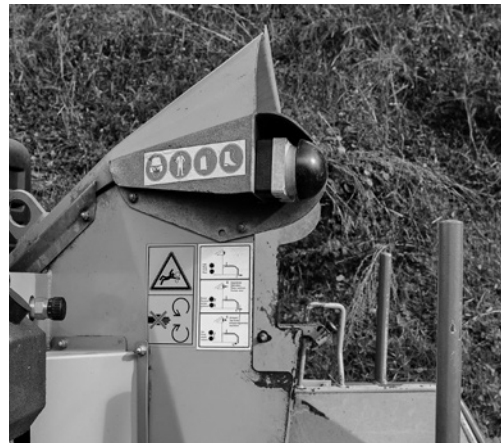
2 Auf dem Zuführtrichter sind die Funktionen des Schaltbügels eindeutig und gut sichtbar beschriftet.
