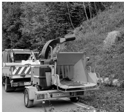
4 Im Auswurfbereich der Schnitzel dürfen sich keine Personen aufhalten. Es ist auch auf den vorbeifahrenden Verkehr zu achten.
