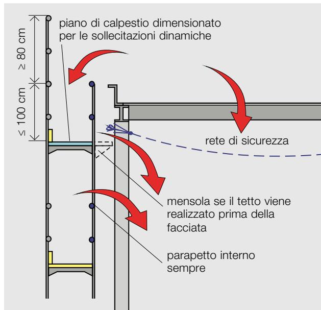
Fig. 23: montaggio intelaiatura
