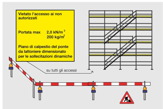
Fig. 4: il carico utile di un ponteggio deve essere indicato in modo ben visibile su cartelli applicati in ogni punto di accesso al ponteggio.
