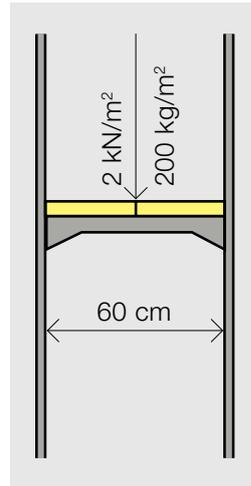
Fig. 2: ponteggio per lavori di intonacatura e pittura
