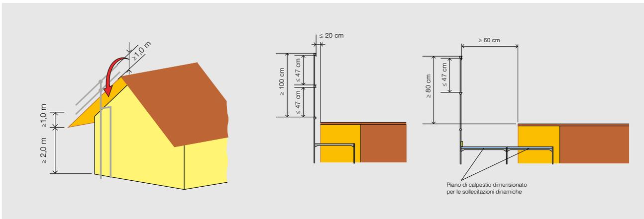
Fig. 22: protezione laterale lungo il lato del frontone
