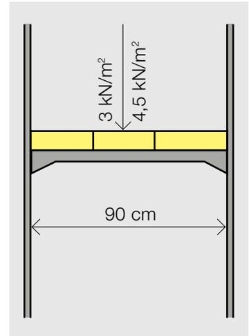
Fig. 3: ponteggio per lavori di muratura/scalpellino
