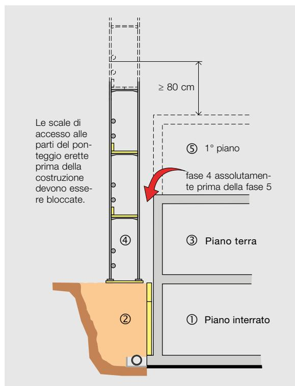
Fig. 5: fasi di installazione da 1 a 5
