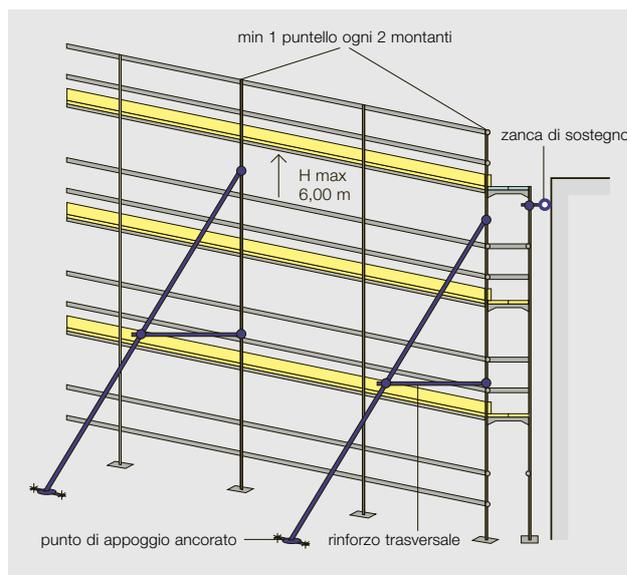
Fig. 16: puntellatura esterna in sostituzione degli ancoraggi
