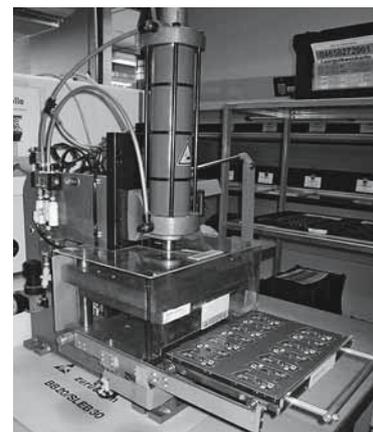
Bild 9: Beschickungseinrichtung (Auslösung des Pressenhubes bei Erreichen der hinteren Position des Tisches, Spaltbreite max. 6 mm)
