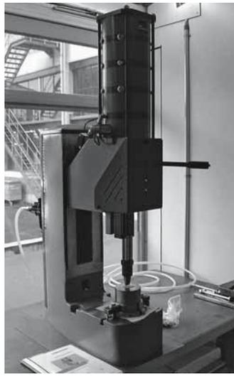
Bild 5: Presse mit manueller Zustellung und pneumatischem Krafthub für maximal 6 mm
