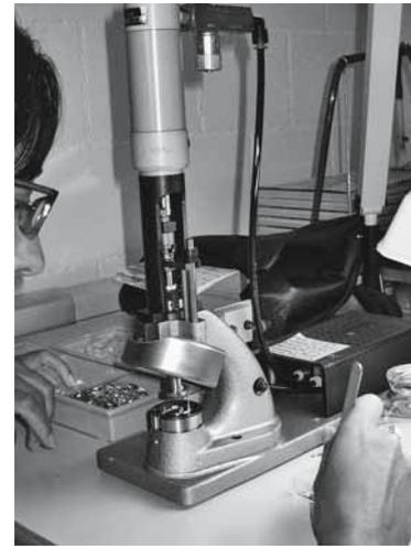
Bild 8: Auslösung des Pressenhubes durch Niederdrücken des Schutzverdeckes (direkte Verriegelung im Pneumatikkreislauf)
