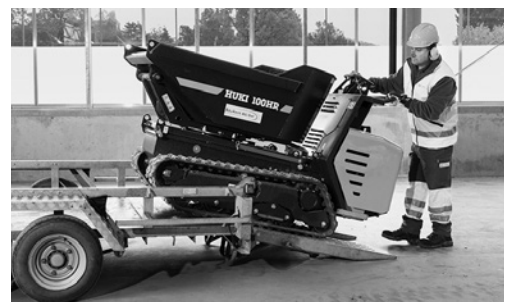
8 Rampe utilisée pour charger une machine sur une remorque.
