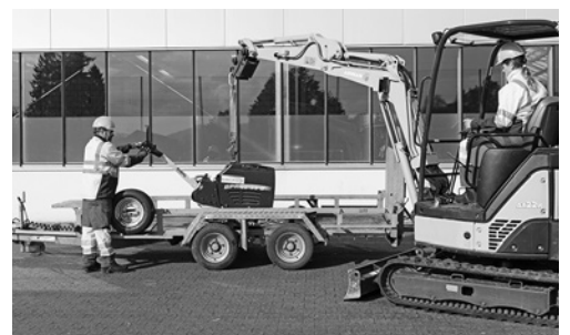
9 La machine est chargée à l'aide d'une mini-pelle.
