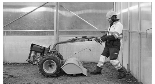
4 Machine avec protection anti-coincement.
