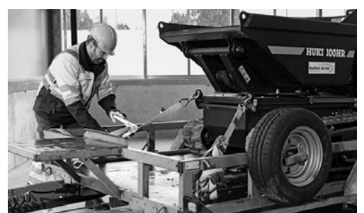
10 La machine est arrimée sur la remorque.
