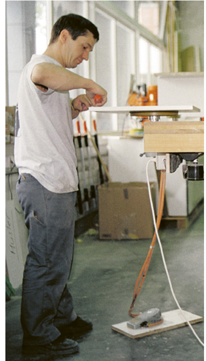
Bild 14, 15 und 16: Bei dieser Hobelbank kann je nach Arbeitsaufgabe eine andere Arbeitshöhe eingestellt werden.
