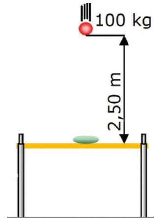
3 und 4: Versuchsaufbau für die dynamische Prüfung
