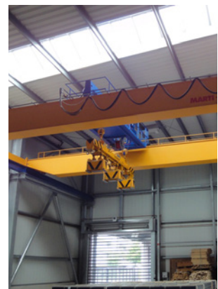
1 Aufstieg, Hubarbeitsbühne, Wartungspodest am Gebäude und Wartungspodeste am Kran (von oben links nach unten rechts)
