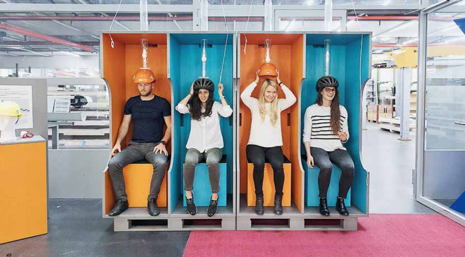
Im Experiment erlebt man, was es heisst, wenn eine Stahlkugel auf den Helm fällt. Die Schutzwirkung des Helms wird so praxisnah vermittelt.
