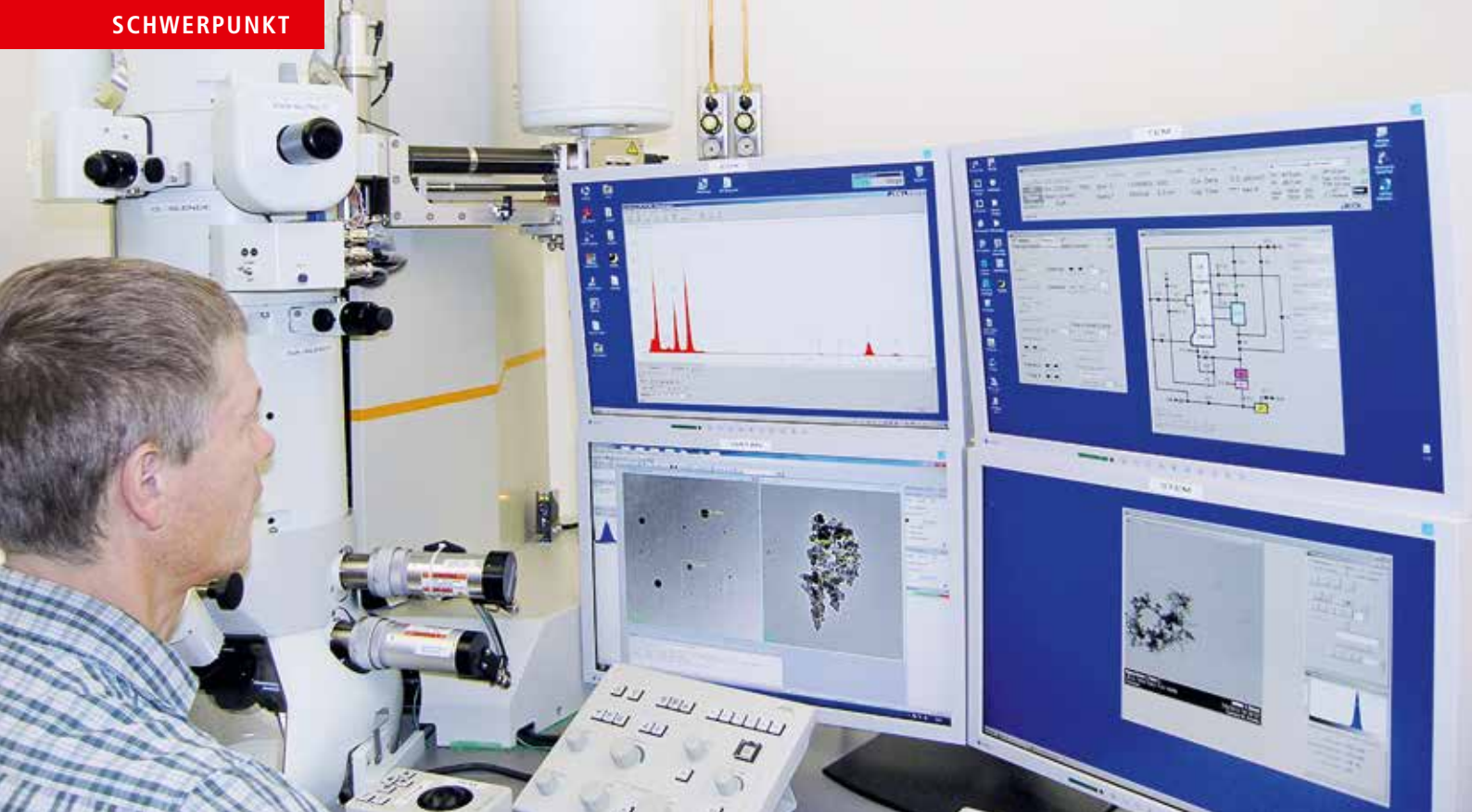
Neue Risiken frühzeitig erkennen: Nanofasern unter dem Transmissions-Elektronen-Mikroskop (TEM)
