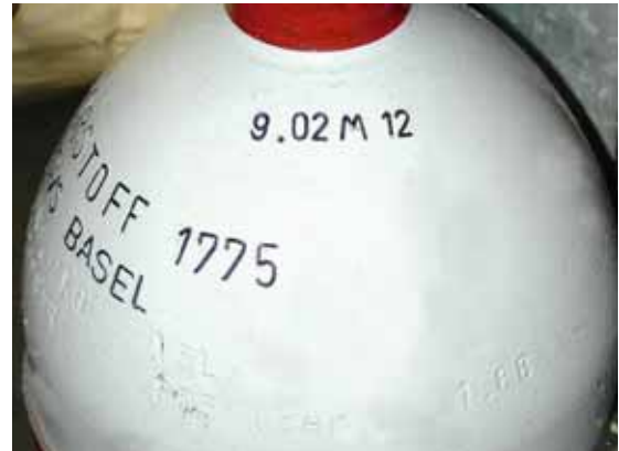
Bild 24: Prüfdatum auf Gasflaschenschulter
