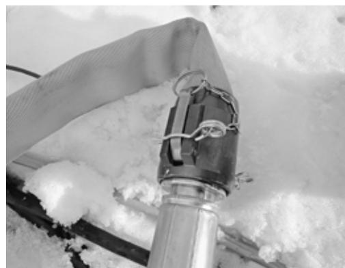
Fig. 1: il raccordo cam-lock è protetto dall'apertura accidentale con una copiglia di tipo beta.
