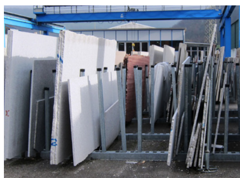
2 Râtelier avec éléments intercalaires pour l'entreposage en toute sécurité des tranches de pierre.
