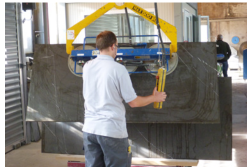
6 Une instruction est nécessaire pour utiliser en toute sécurité les palonniers à ventouses.
