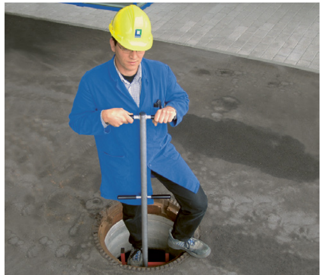
1 Canne utilisée pour descendre dans un regard de visite
