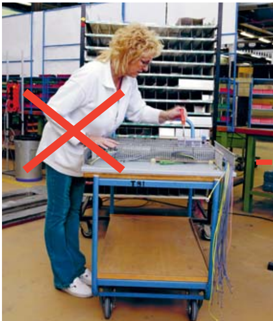
Figure 7 Buste fléchi en avant: ce chariot n'est pas destiné à servir de support de montage.
