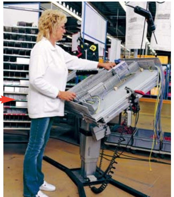
Figure 8 Ce support de montage inclinable et réglable en hauteur permet d'adopter une posture correcte.
