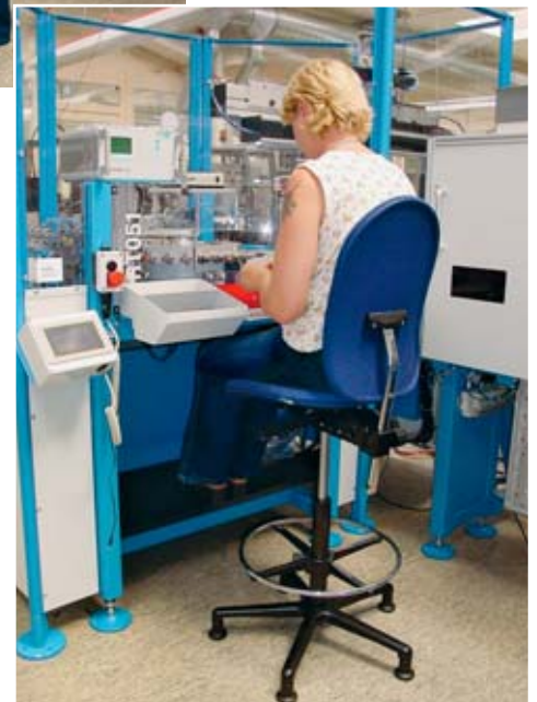
Bild 25 Mit korrekter Sitzeinstellung und Fussstütze kann auf gleicher Höhe gearbeitet werden wie beim Stehen.
