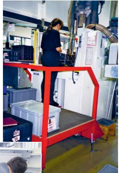
Bild 20 Elektrisch höhenverstellbares Arbeitspodest.
