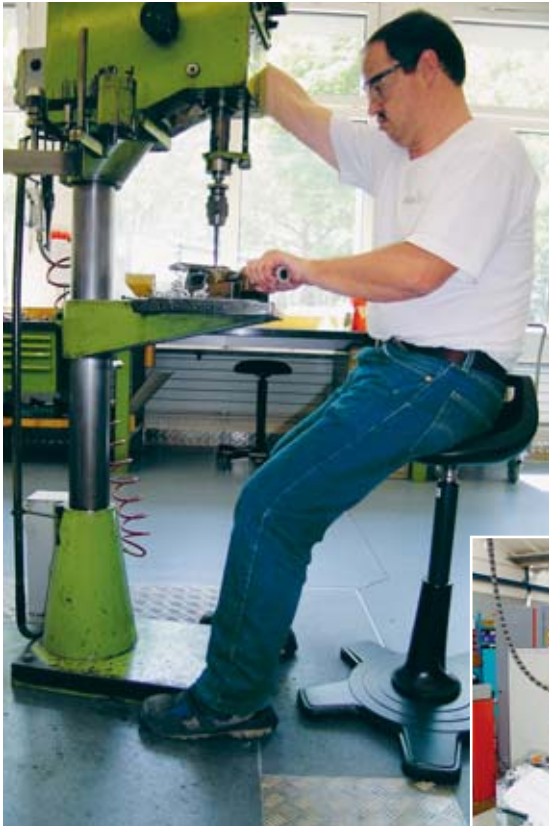
Bild 17 Elektrisch höhenverstellbarer Montagestand.
