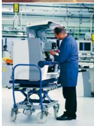
Bild 19 Hubwagen mit Fusspedal zur Höhenverstellung.
