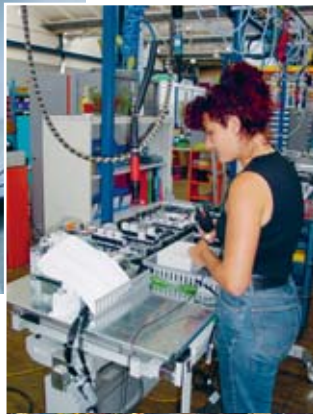
Bild 17 Elektrisch höhenverstellbarer Montagestand.
