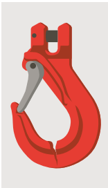
11 Risse im Hakengrund
