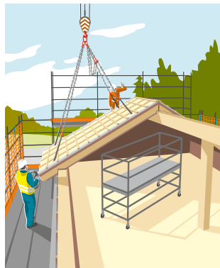
Regel 6 Die Last sicher anschlagen
