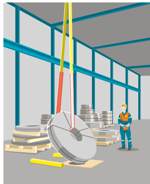
Regel 7 Die Anschlagmittel vor Beschädigungen schützen
