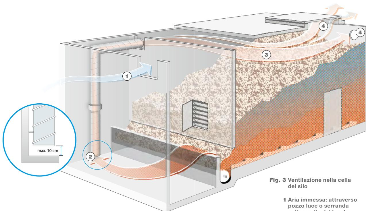
**Fig. 3** Ventilazione nella cella del silo
