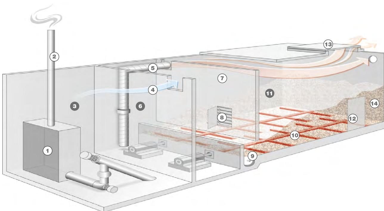
Fig. 1 Impianto termico con silo per minuzzoli
