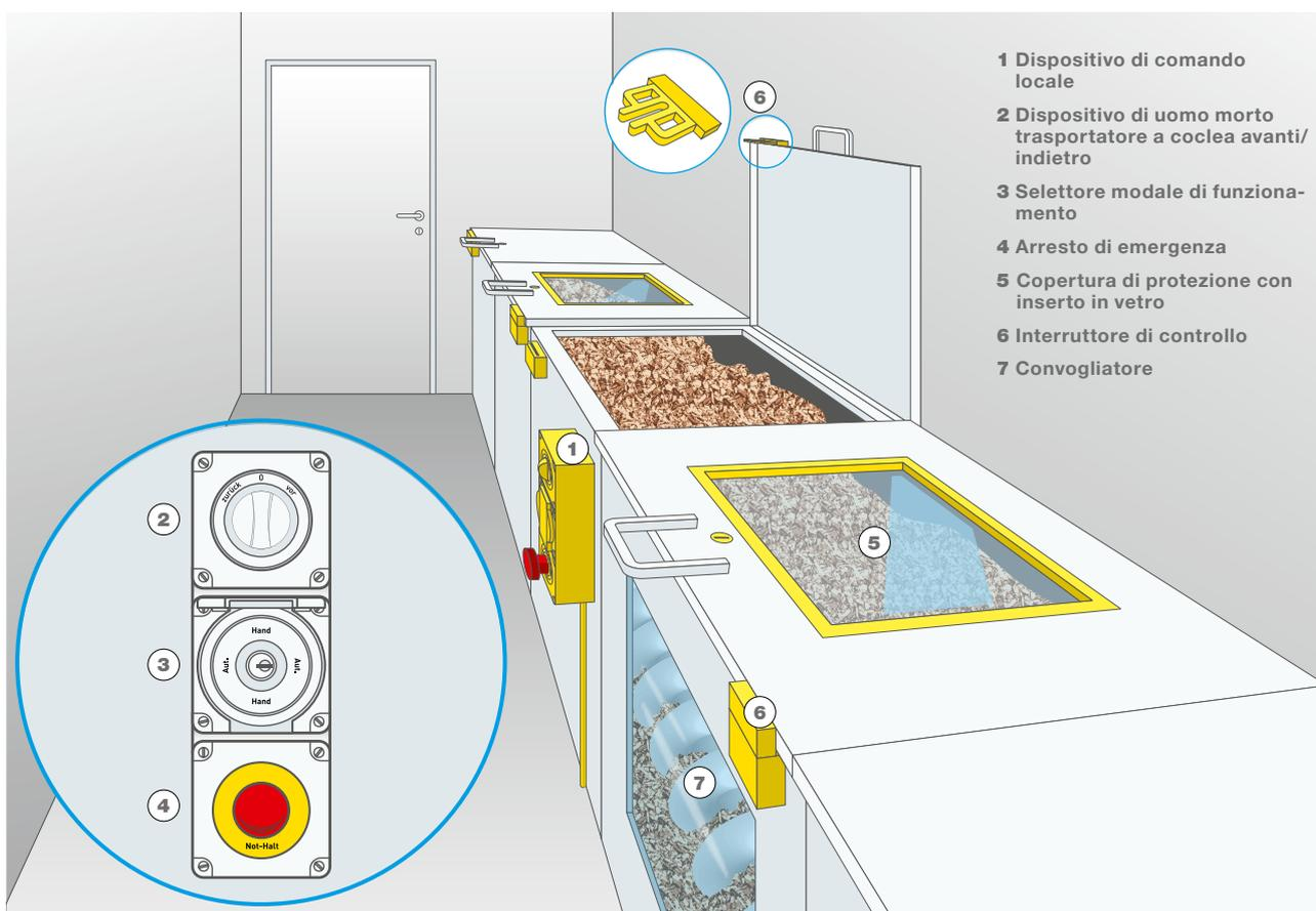
**Fig. 4** Trasportatore a coclea in un canale chiuso
