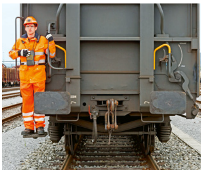
2 Accompagnement du véhicule sur le marchepied: se tenir fermement avec les deux mains
