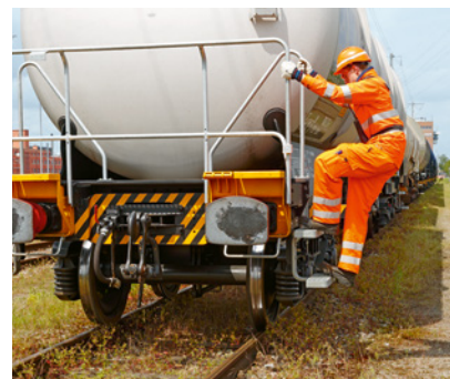
3 Descente du véhicule à reculons: se tenir fermement avec les deux mains
