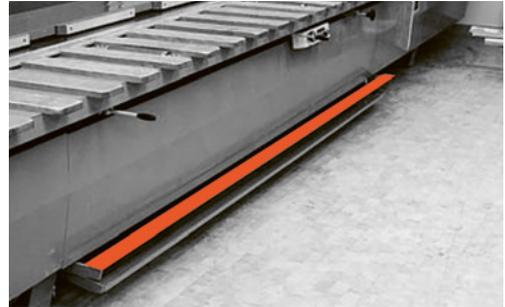
1 Die Verdeckung über der Fusschaltstange verhindert ein unbeabsichtigtes Ingangsetzen des Sägeblattes.
