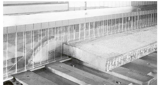
5 Schutz- und Absaugbalken. Bei abgesenktem Balken kann nicht mehr unbeabsichtigt in die Schnittebene gegriffen werden und die anfallenden Späne werden besser abgesogen.
