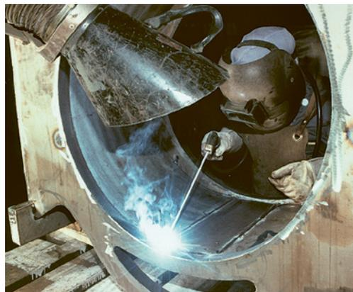
4 Cappa flessibile, a forma di coclea, per la cattura e l'aspirazione dei fumi di saldatura
