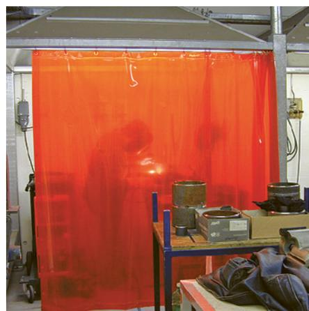
8 Per schermare i posti di lavoro vicini all'area di saldatura occorre utilizzare, ad esempio, pareti divisorie mobili di tipo ignifugo o tende di saldatura (gli schermi trasparenti devono soddisfare i requisiti della norma SN EN 1598).
