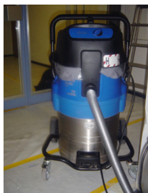
2 Aspiratore industriale con filtro di classe H (amianto)
