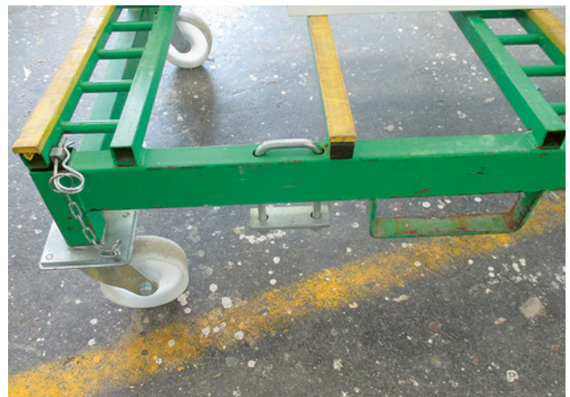
2 Rastrelliera di trasporto con ruote smontabili, punti di aggancio alla gru e attacchi per le forche (trasporto tramite carrelli elevatori)
