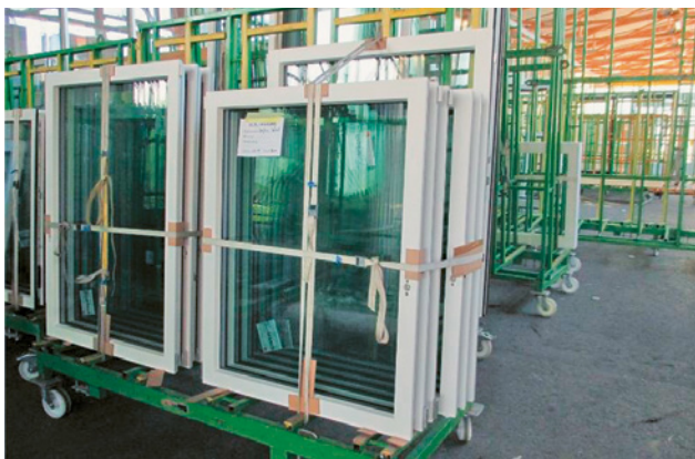
3 Il trasporto può avvenire in condizioni di sicurezza se le rastrelliere vengono caricate correttamente.
