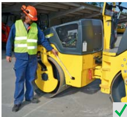
Fig. 2 Rouleau compresseur avec FAP installé dans le compartiment moteur. La visibilité du conducteur n'est pas réduite.
