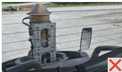
Fig. 4 Angle mort dû à un FAP monté en post-équipement.
