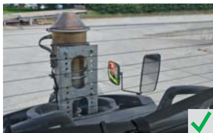
Fig. 5 Rétroviseurs supplémentaires permettant d'éviter les angles morts.
