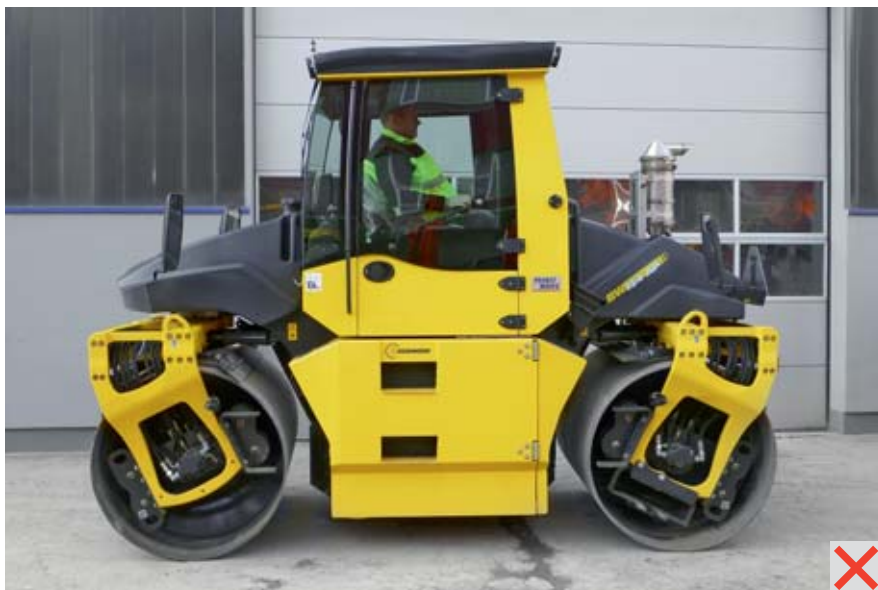
Fig. 3 Rouleau compresseur à siège pivotant. Le FAP monté en post-équipement à l'arrière de l'engin réduit la visibilité en marche arrière dans le sens de la marche.
