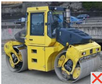
Fig. 1 Rouleau compresseur avec FAP installé hors du compartiment moteur. La visibilité du conducteur est réduite.
