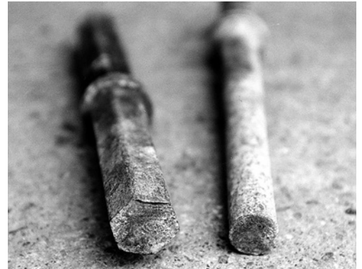
7 Diese Eisen sind bei sehr tiefen Temperaturen so spröde geworden, dass sie wie Glas entzwei-brachen.
