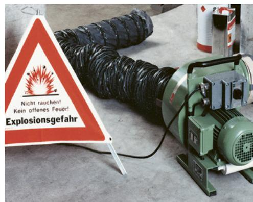
5 Une aération artificielle est nécessaire dans les caves. Le cas échéant, des ventilateurs mobiles seront utilisés.
