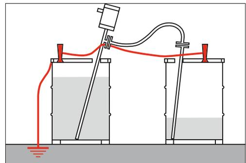
**4 Un équilibrage du potentiel ainsi qu'une mise à la terre jouent un rôle important pour éviter la formation de décharges d'électricité statique pouvant provoquer des explosions.**
