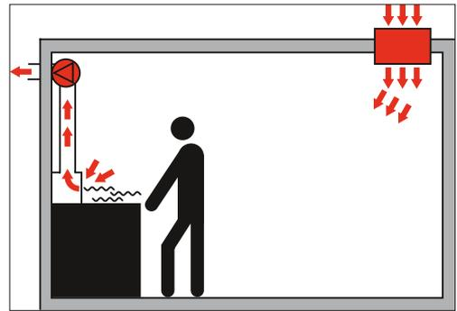
**2 L'efficacité des installations de ventilation dépend de l'amenée d'air.**
