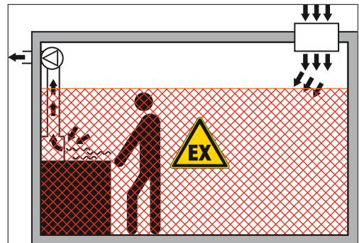
**3 Des mesures appropriées doivent être prises dans les zones exposées à un risque d'explosion afin d'y éviter l'introduction de sources d'ignition.**
