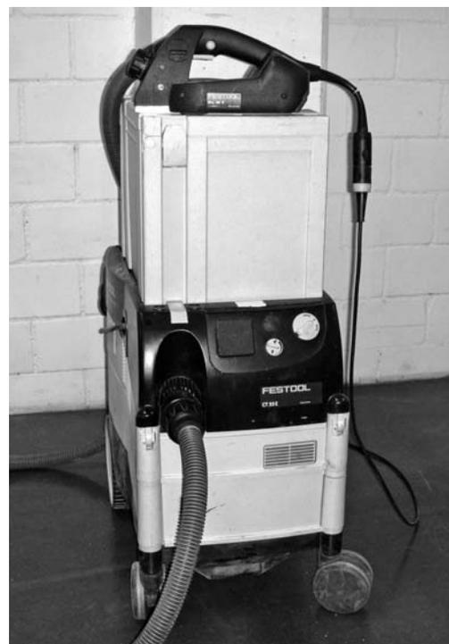
Fig. 4: pialla portatile dotata di aspiratore
