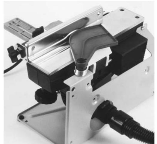
Fig. 2: pialla portatile usata in modo stazionario, equipaggiata con schermatura dell'albero portacoltelli e con basamento.
