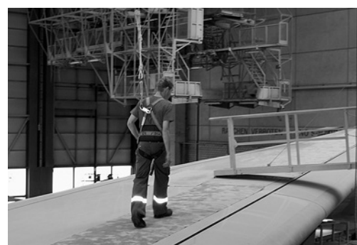
7 Operaio che lascia la piattaforma di lavoro con il suo dispositivo di protezione anticaduta.
