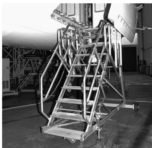
2 Scala per manutenzione con meccanismo di arresto e parapetti superiori abbassati
