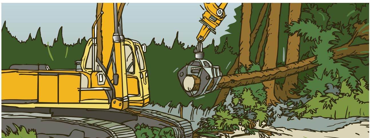
Grâce à des moyens techniques appropriés, les arbres encroués peuvent être mis à terre rapidement et en toute sécurité.
