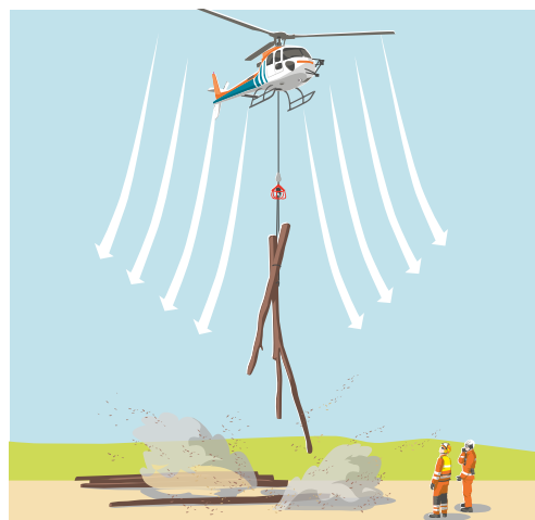
3 Pericolo dovuto al vortice d'aria generato dai rotori (downwash)
